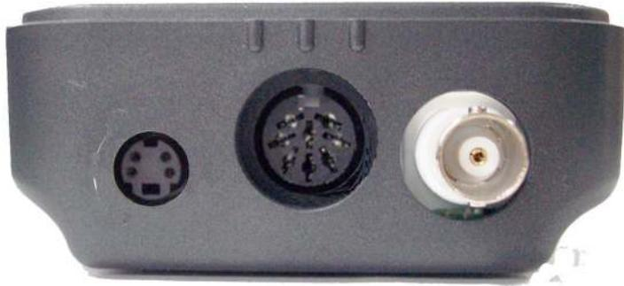
DIN4P (Power /RS232) DIN8P(Temp.) BNC(Electrode)
